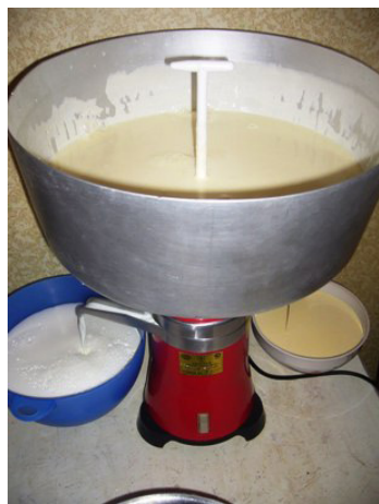
Процесс отделения сливок при помощи сепаратора
